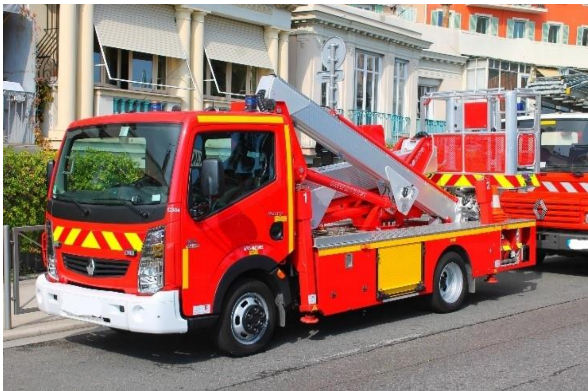
Bras élévateur articulé de 19 m
