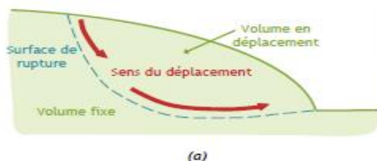
Figure 8 : (a) Schématisation du phénomène de glissement de terrain plan, (b) avalanche, image [7]
