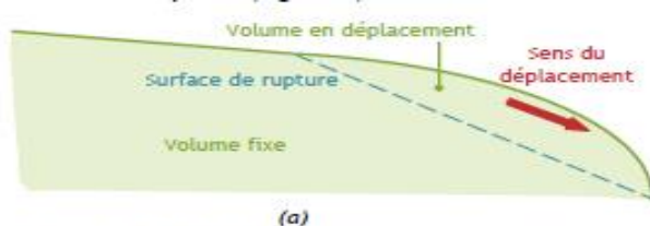
Figure 8 : (a) Schématisation du phénomène de glissement de terrain plan, (b) avalanche, image [7]
